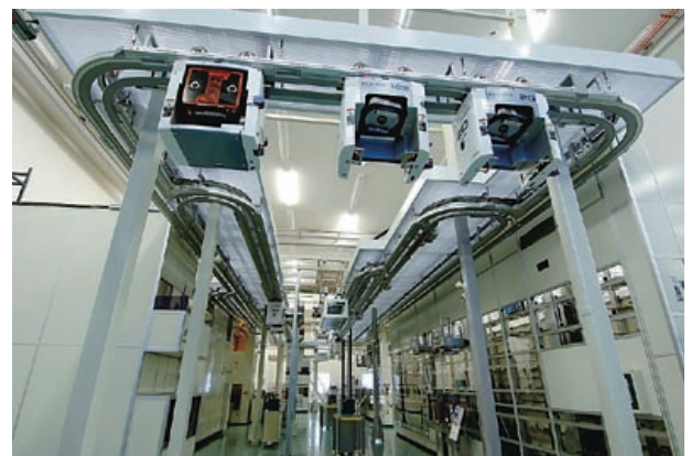
図4 ワイヤレス電力伝送を使用したクリーンルーム用DAIFUKUマテリアルハンドリングシステム
