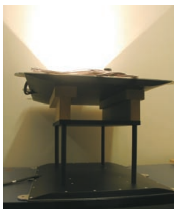
図3 0.5mのエアギャップでの2kWワイヤレス電力伝送
