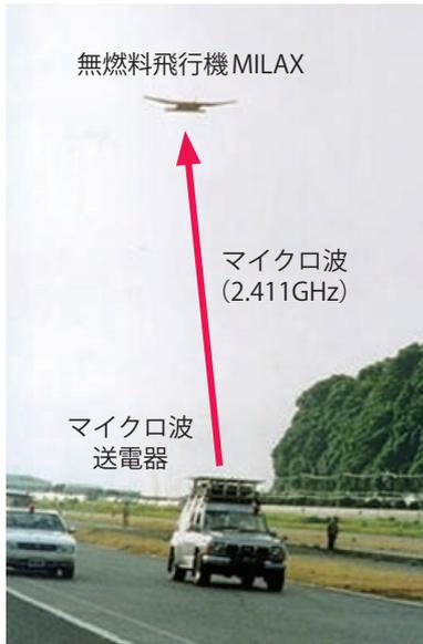
図8 ワイヤレス給電式飛行機<sup>3)</sup>
