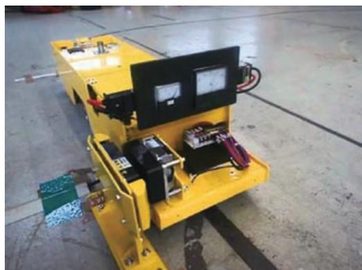
図3 ワイヤレス給電式AGV
