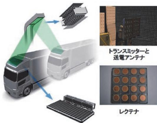
図21 マイクロ波による走行中給電のイメージ
