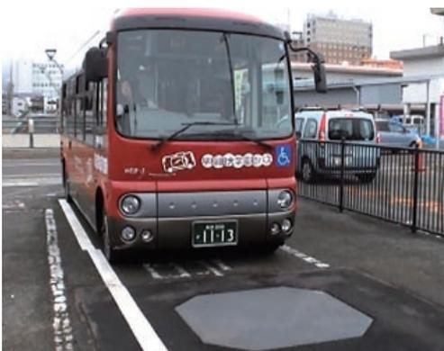
図1 ワイヤレス給電式電気バスWEB-3
