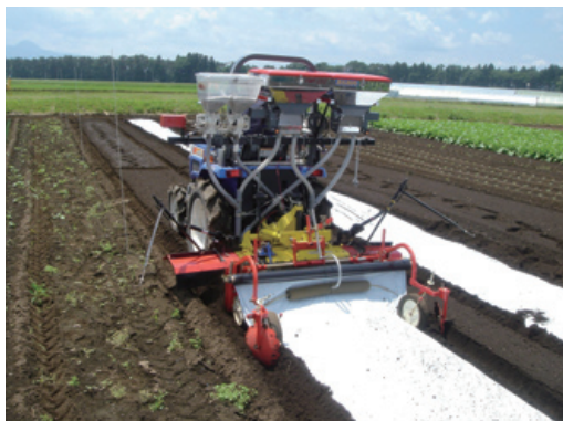
図11 うね内部分施用機の汎用利用法
