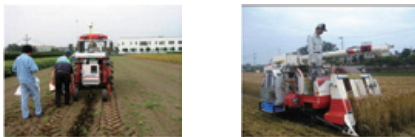
リアルタイム土中光センサー 収量メーター付きコンバイン リアルタイム土中光センサーによる近赤外反射スペクトルの取得 自脱式収量コンバインによる小麦収量データの取得
