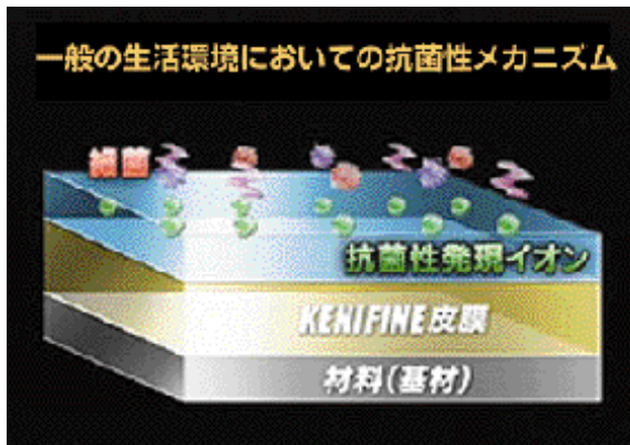
写真9 24) 抗菌メッキのメカニズム
