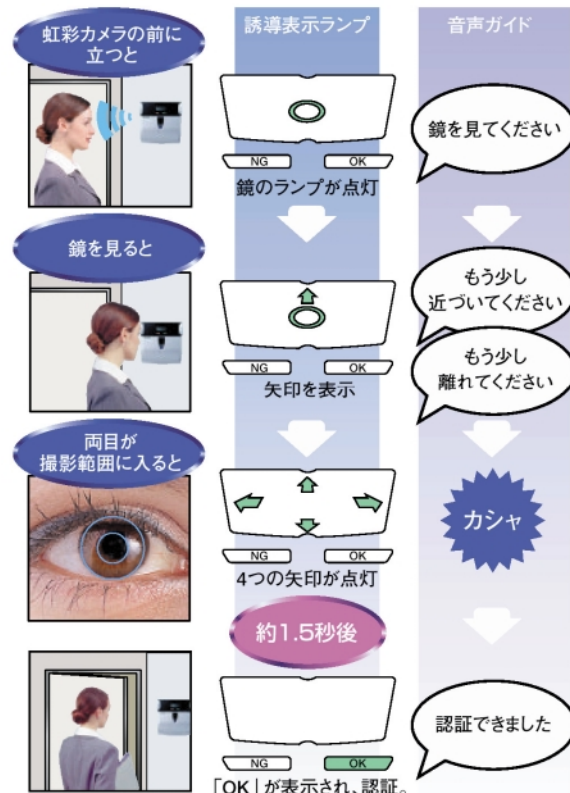
図8 半自動方式による撮影プロセス
