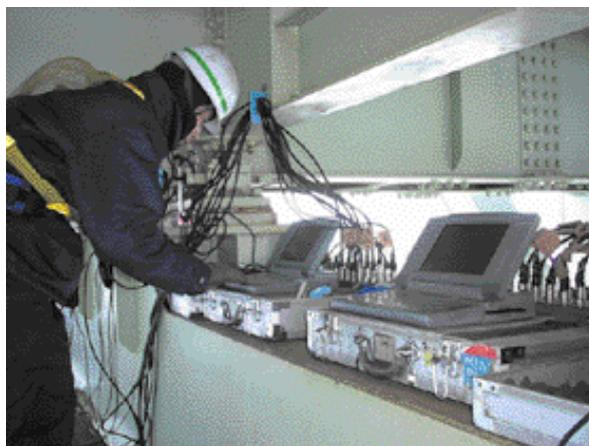
図-1 橋の余寿命診断作業
